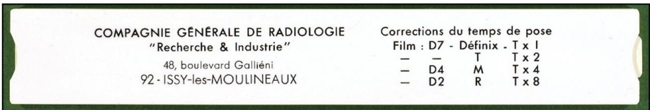
118 ALSTOM Radiographie industrielle de l'acier 185x60 Règle en matière plastique fine. Pour utilisation d'une radio-source en Iridium 192. Temps de pose [distance source-film/activité de la source (2 échelles)] épaisseur Fe en mm. Logo ALSTOM
