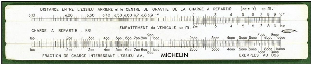
Faire coulisser la règlette mobile en amenant l'indication de l'empattement du véhicule sous la cote Y. Faire la lecture de la charge intéressant l'essieu AV sous le chiffre indiquant la charge à répartir.
